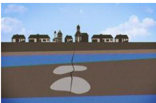
Eine leichte Verschiebung der Gesteine unter Staufen könnte Grundwasser mit Anhydrit in Kontakt gebracht haben
