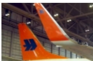
Die neue Form der Tragflächenspitzen sparen Treibstoff
