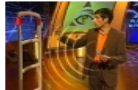
Diebstahlsicherungsanlagen regen mit elektromagnetischen Wellen Chips in Transpondern an
