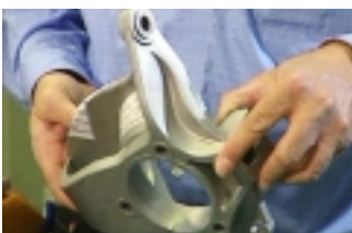
Ein Achsschenkel nach den Regeln des Knochenwachstums optimiert
