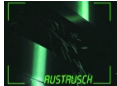
Der Luftaustausch durch ein gekipptes Fenster ist nur gering
