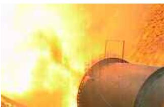
Bis heute wird an Grubengas- und Kohlenstaubexplosionen geforscht. Für diese Explosion wurden sechs Eimer Kohlenstaub in einer großen Versuchsrohre aufgewirbelt
